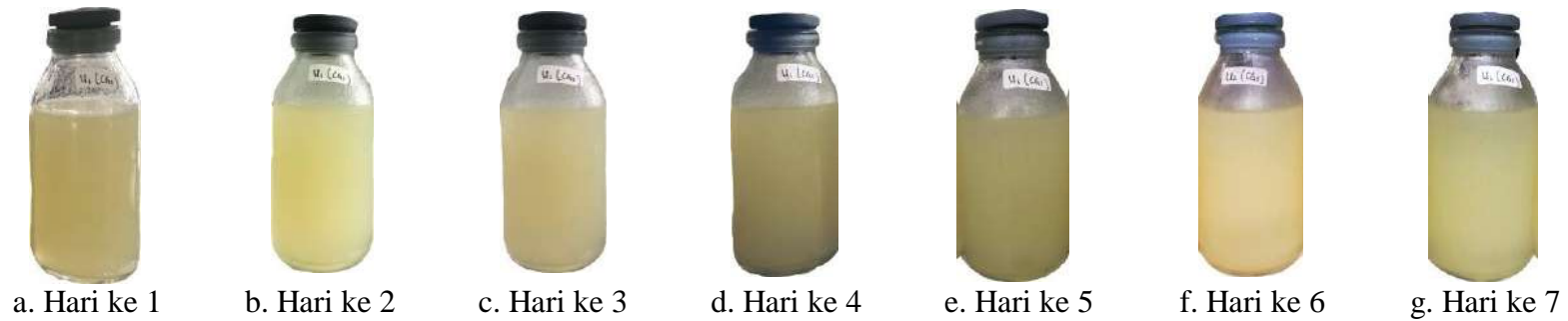
Gambar 16. Kestabilan Suspensi Perlakuan CG5 (1,00 : 0,00) Dari Hari Ke-1 Hingga Hari Ke-7
