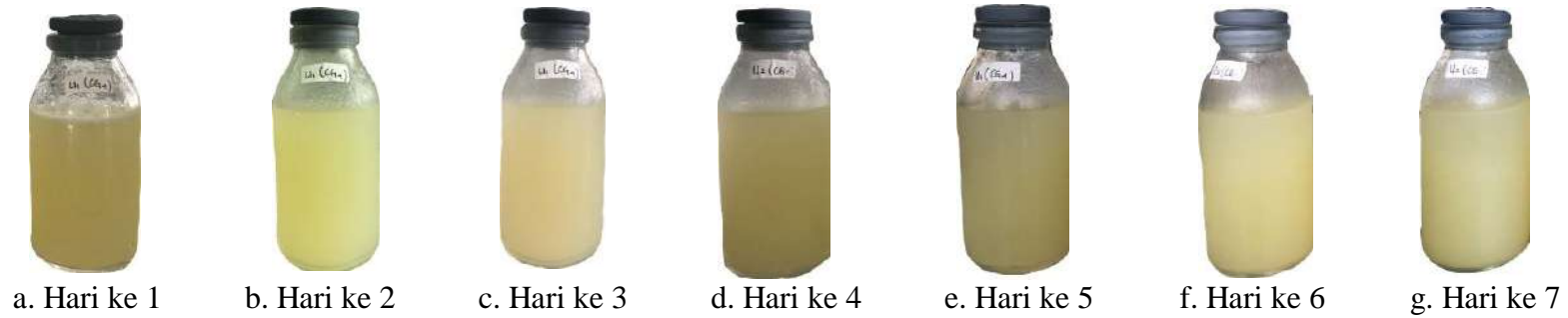
Gambar 15. Kestabilan Suspensi Perlakuan CG4 (0,75 : 0,25) Dari Hari Ke-1 Hingga Hari Ke-7
