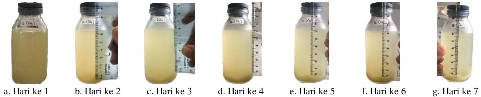
Gambar 12. Kestabilan Suspensi Perlakuan CG1 (0,00 : 1,00) Dari Hari Ke-1 Hingga Hari Ke-7
