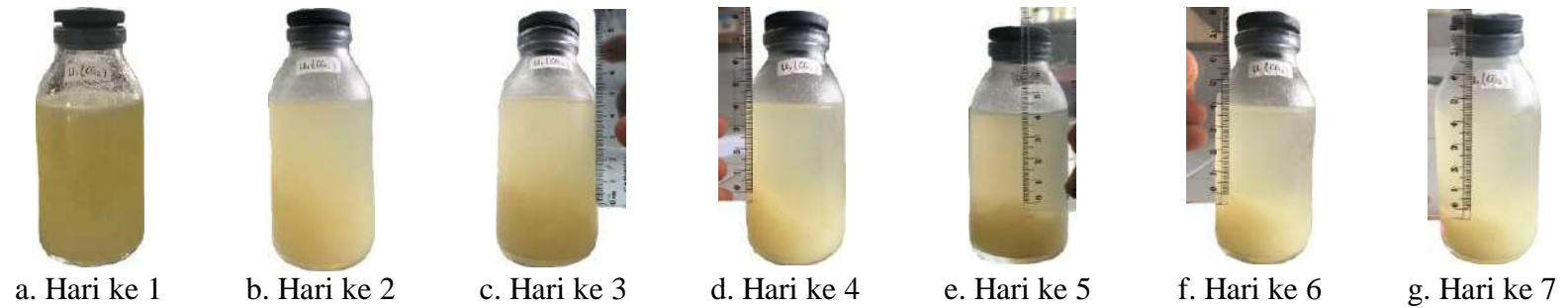
Gambar 13. Kestabilan Suspensi Perlakuan CG2 (0,25 : 0,75) Dari Hari Ke-1 Hingga Hari Ke-7
